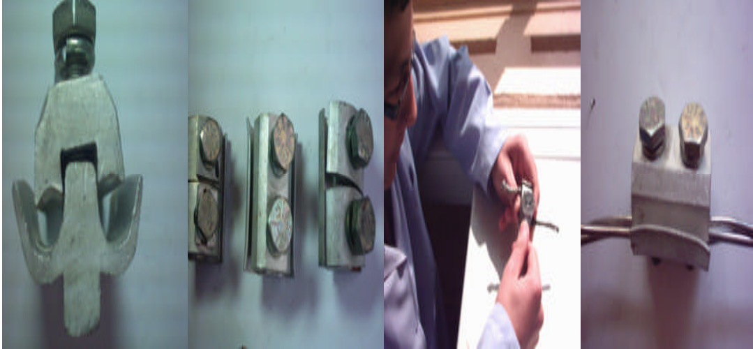
Resim 2.6.b: Alüminyum hat klemensi bağlantısı yapılması
