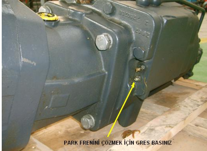
Resim 4.2: Park freni devre dışı bırakma gresörlüğü (iş makineleri için)
