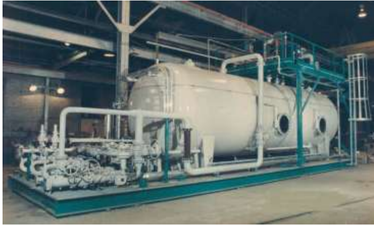
Resim 2.1: Endüstriyel elektrostatik tek aşamalı desalter (tuz giderici) ünitesi
