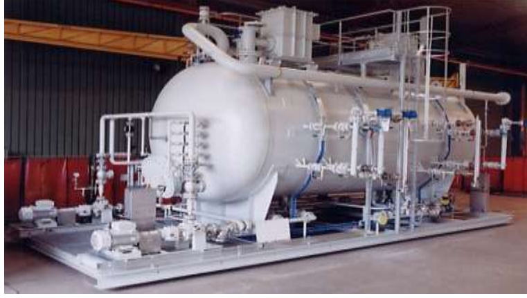
Resim 2.2: Endüstriyel elektrostatik iki aşamalı desalter (tuz giderici) ünitesi
