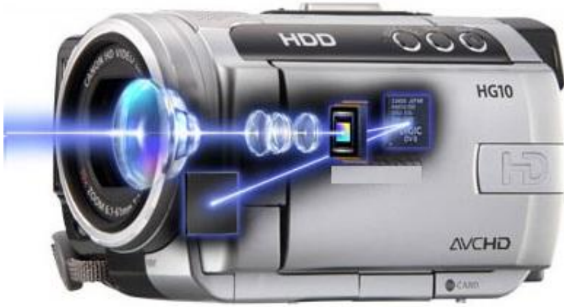
Şekil 1.18: Kameranın mercek düzeneği ve çalışma şekli
