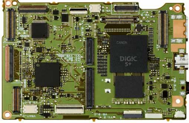
Resim 1.5: Devre kartı üzerinde yer alan DIGIC görüntü işlemcisi
