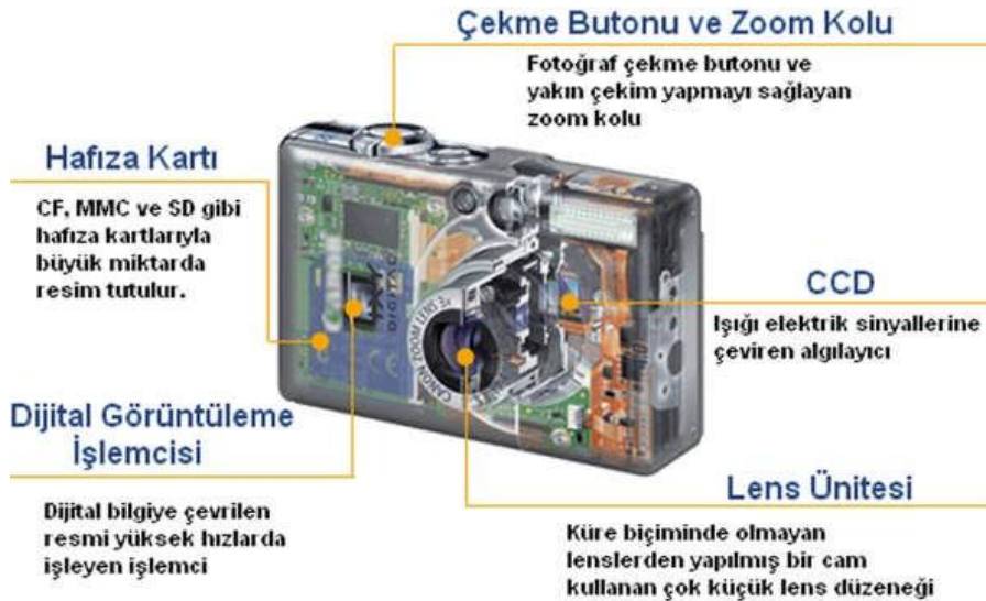
Şekil 1.1: Klasik dijital kameranın yapısı
