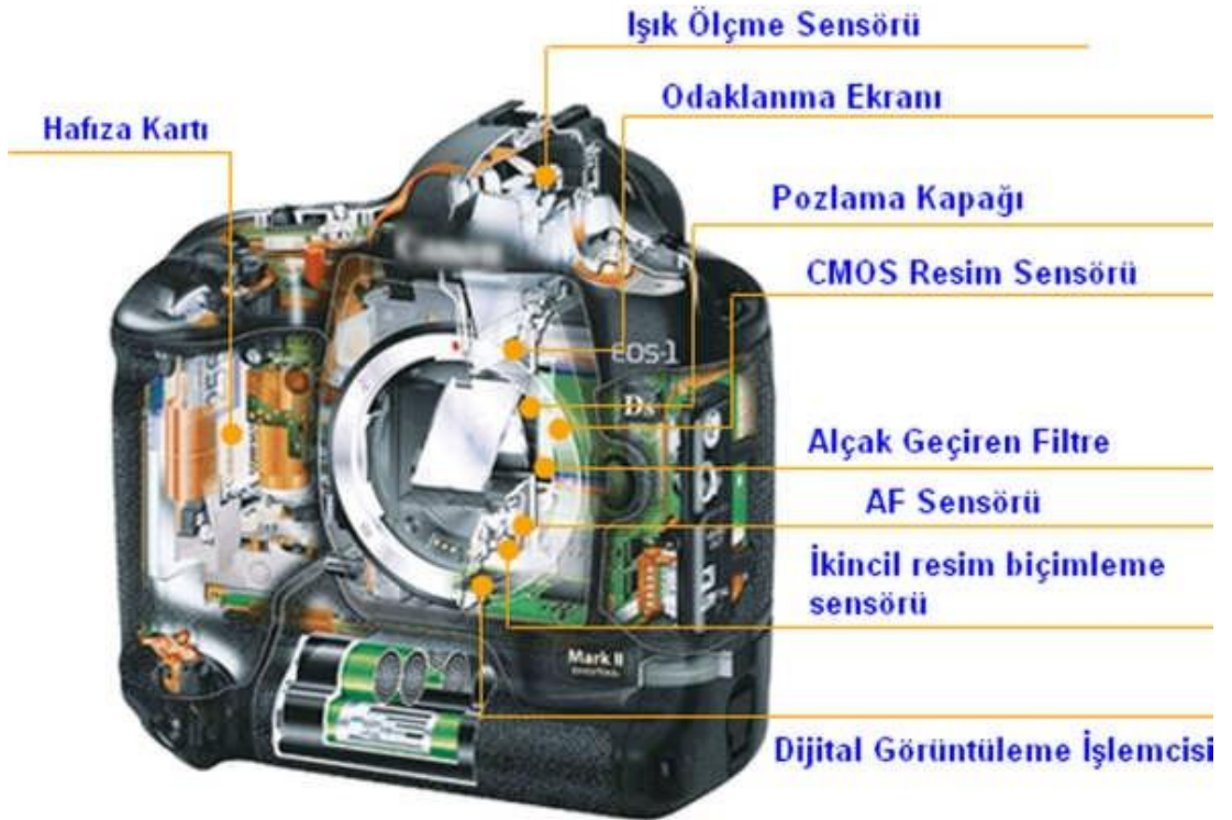
Şekil 1.2: Dijital SLR kameranın yapısı
