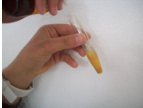
Resim 1.2: Baryum tuzu çözeltilerine ister potasyum kromat çözeltisi ilavesi
