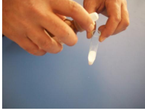
Resim 1.3: Baryum tuzu çözeltisine seyreltik sülfürik asit ilavesi
