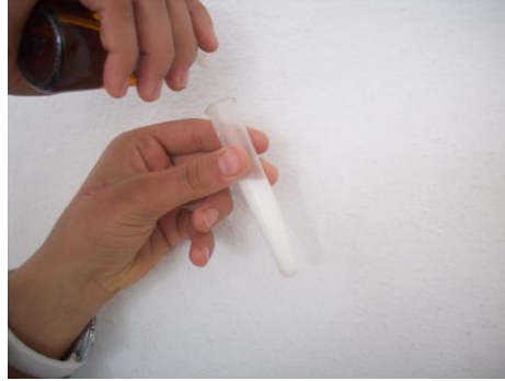
Resim 1.4: Baryum tuzu çözeltisine alçı eklenmesi
