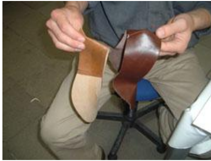
Resim 3.4: Astarın yüze merkezlenmesi
