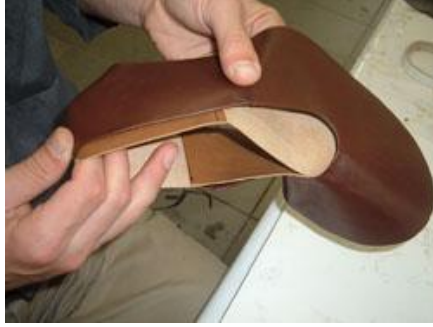
Resim 3.5: Astarın yüze merkezlenmesi
