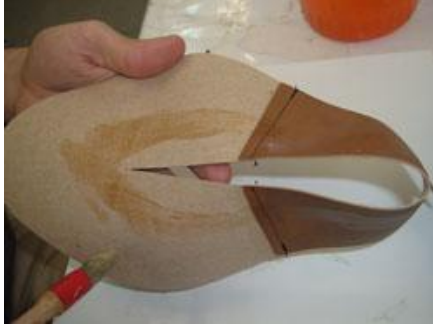
Resim 3.3: Astara yapıştırıcı sürme
