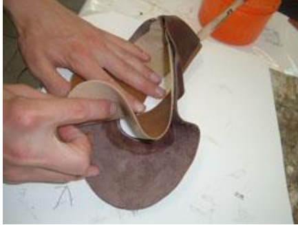
Resim 3.6: Astarın yüze yapıştırılması
