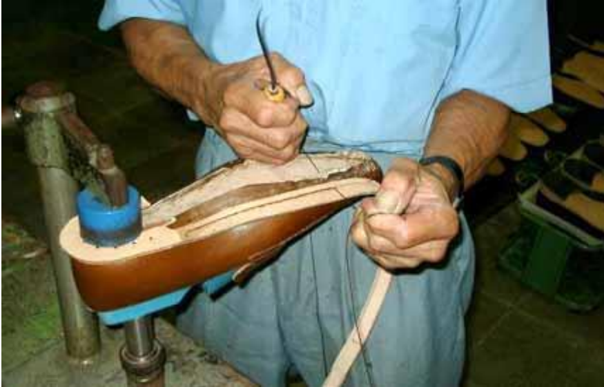
Resim 2.3: Şerit vardolanın mengenede sabitlenerek elde dikilmesi
