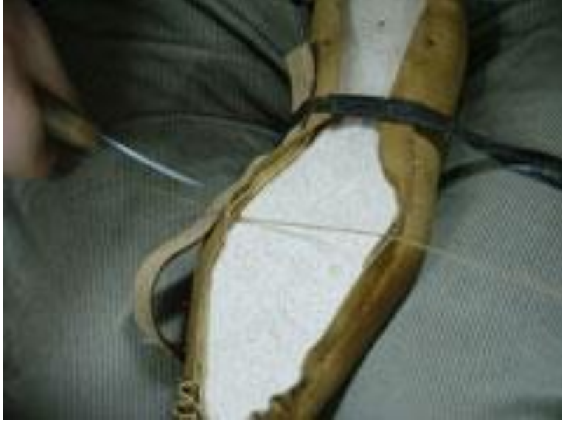
Resim 2.2: Şerit vardolanın ayağa sabitlenerek elde dikilmesi
