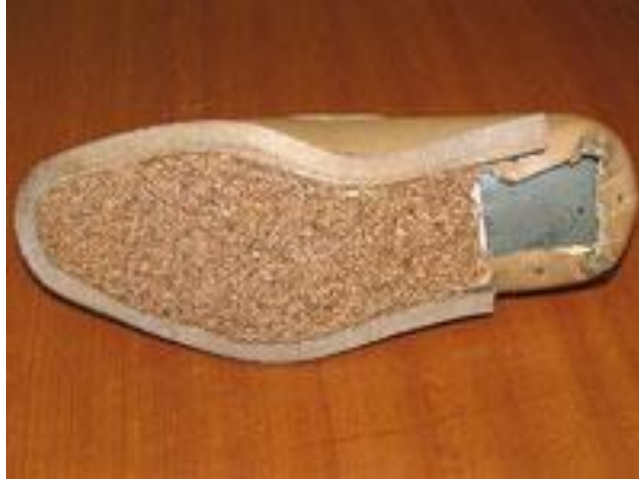
Resim 2.4: Dolgunun yapıştırılmış hâli
