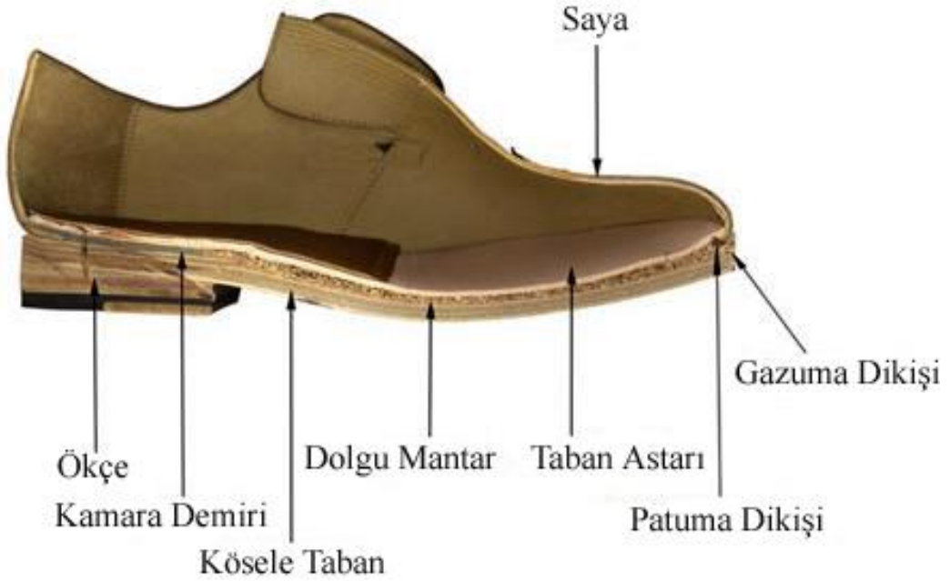
Şekil 1.2: Goodyear welt ayakkabının kesit görünümü
