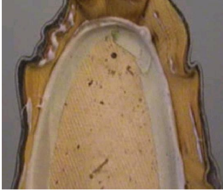
Resim 1.7: Goodyear welt ayakkabının ön montasının yapılmış hâli
