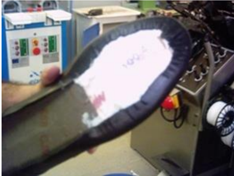
Resim 1.5: Normal bir ayakkabının ön montajının yapılmış hâli
