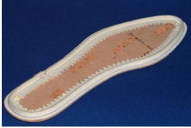
Resim 1.1: Çıkıntılı (fitilli) taban astarı
