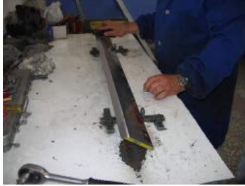
Resim 1.5: Bileme işlemi sonunda bıçak yüzeyindeki kırıntı, kırıntı alma taşı ile alınır.
