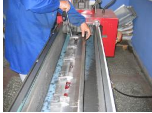
Resim 1.2: Bilencek bıçak makineye yerleştirilerek cıvataları sıkılır.
