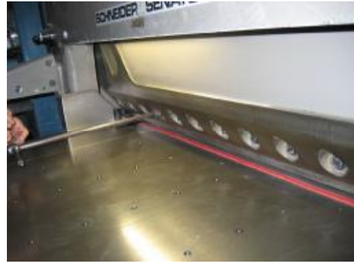
Resim 2.5: Giyotinin elle kumanda anahtarı ile dönüş noktasına kadar indirilerek tüm civataların sıkılması
