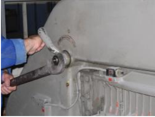
Resim 3.2: Yükseklik ayarının anahtar ile yapılması
