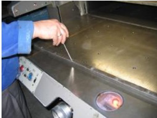
Resim 3.4: Giyotin çıtasının çıkarılıp civatalarının sökülmesi
