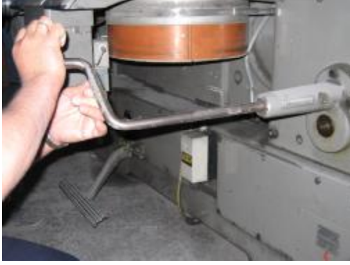
Resim 1.8: Bıçağın elle kumanda anahtarı ile indirilmesi
