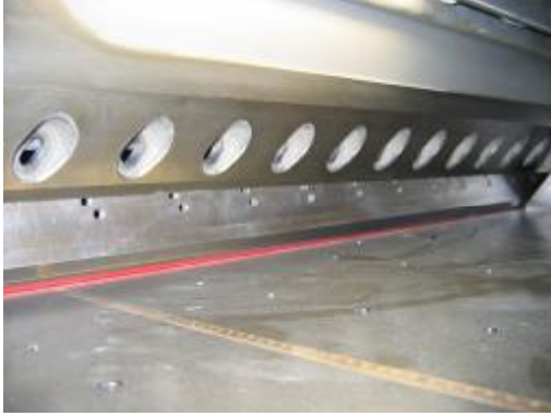
Resim 2.2: Giyotinin elle kumanda anahtarı ile indirilerek civata deliklerinin hizalanması
