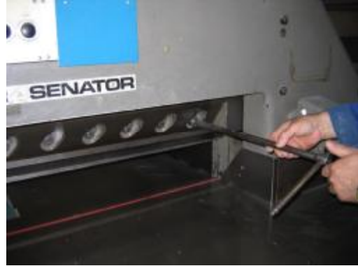
Resim 1.7: Bıçağın en sonundaki civatanın bıçak tespit civata anahtarı ile sökülmesi
