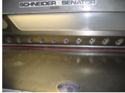
Resim 2.2: Giyotinin elle kumanda anahtarı ile indirilerek civata deliklerinin hizalanması
