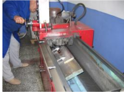
Resim 1.3: Bıçağın eğimi ayarlanır ve makine çalıştırılır.
