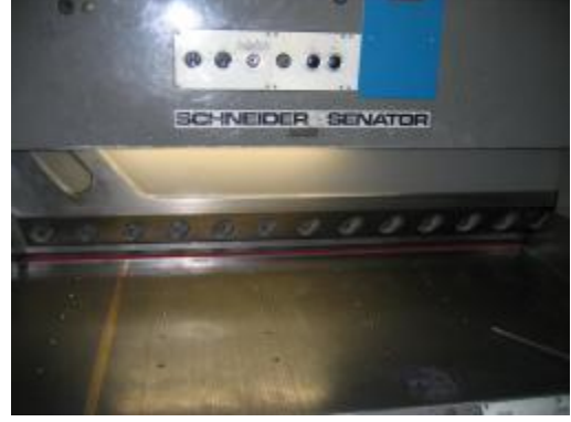
Resim 1.8: Bıçağın elle kumanda anahtarı ile indirilmesi
