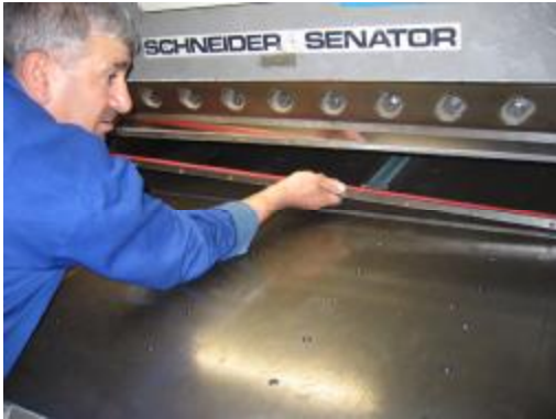
Resim 3.4: Giyotin çıtasının çıkarılıp civatalarının sökülmesi
