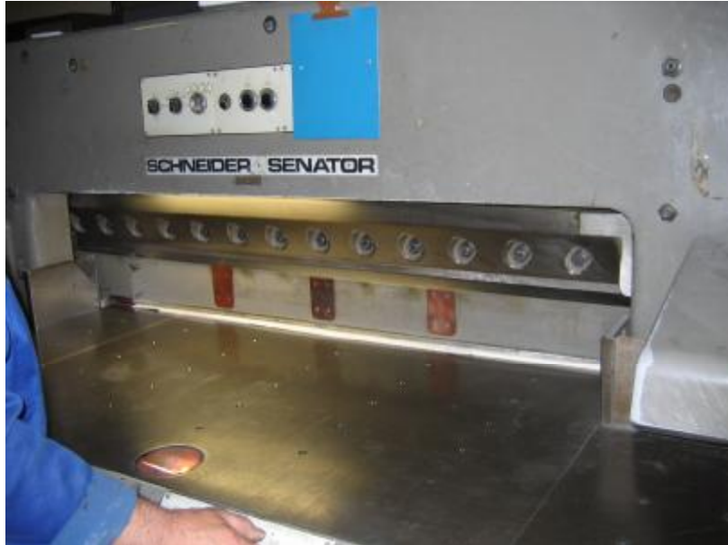
Resim 3.1: Pelür kâğıt kesilerek yükseklik ayarının kontrolünün yapılması
