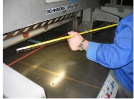
Şekil 1.10: Bıçağın kaldırılması ve 2 adet bıçak tutma kolu ile yerinden alınması
