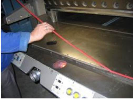
Resim 3.5: Eski ıtanın ıkarılıp yeni ıtanın pelür kağıtla beslenerek takılması
