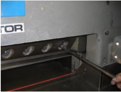
Resim 2.4: Giyotinin kaldırılarak en son civatanın sıkılması
