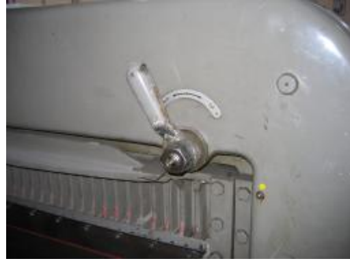
Resim 3.2: Yükseklik ayarının anahtar ile yapılması
