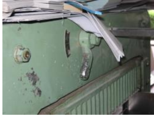
Resim 3.3: Kağıt kesilerek bıçağın arkasındaki anahtardan çarpıklık ayarının yapılması
