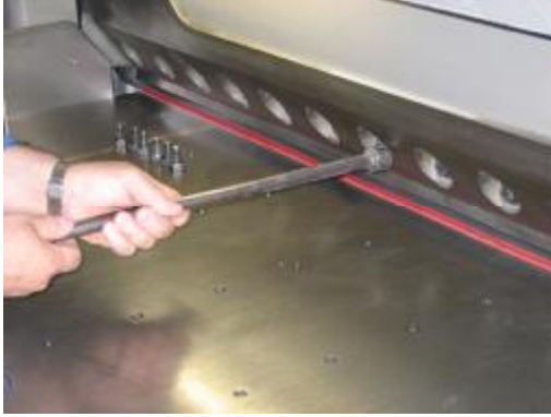
Resim 1.9: Bıçağın civatalarının bıçak tespit civataları anahtarı ile sökülmesi
