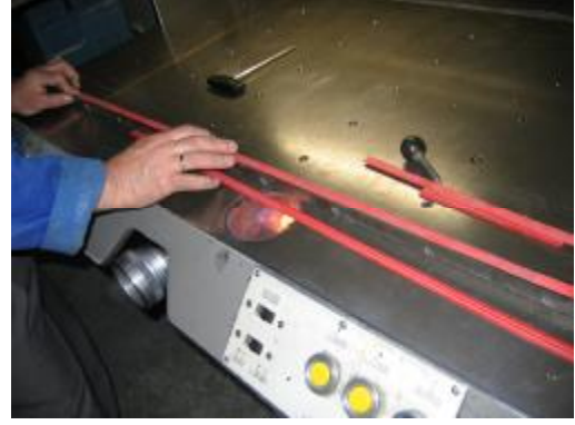
Resim 3.5: Eski ıtanın ıkarılıp yeni ıtanın pelür kağıtla beslenerek takılması
