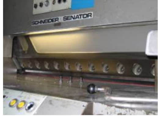
Resim 1.9: Bıçağın civatalarının bıçak tespit civataları anahtarı ile sökülmesi
