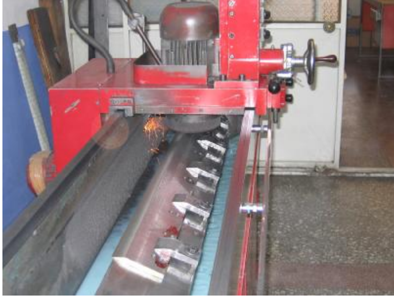
Resim 1.4: Bileme taşının bileme işlemini yapmak için çalışır.
