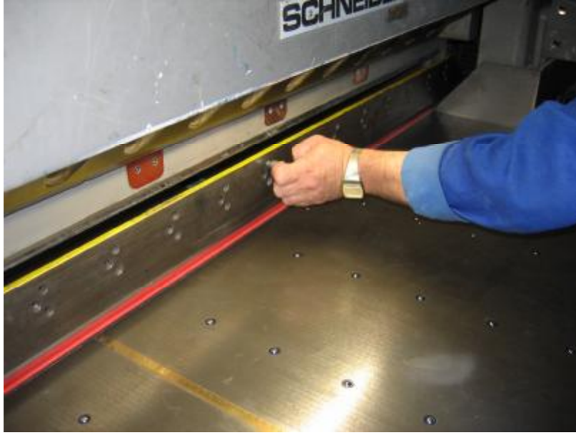
Resim 2.1: Yeni bıçağın iki adet bıçak tutma kolu ile yuvasına oturtulması
