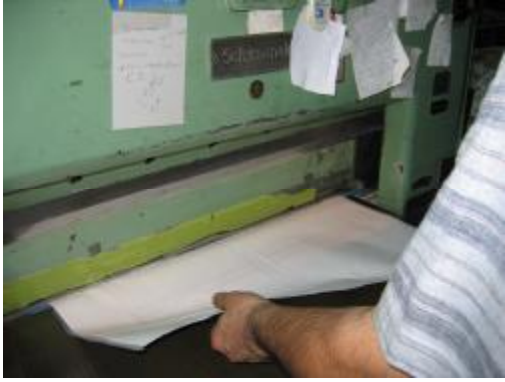
Resim 3.3: Kağıt kesilerek bıçağın arkasındaki anahtardan çarpıklık ayarının yapılması
