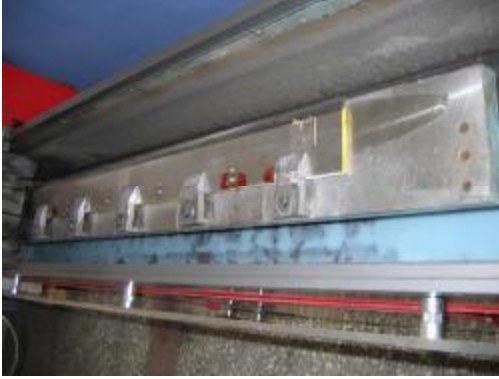
Resim 1.2: Bilencek bıçak makineye yerleştirilerek cıvataları sıkılır.
