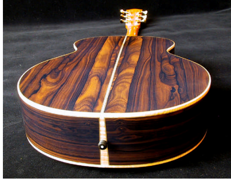
Resim 1.43: Üst yüzey uygulaması bitmiş akustik gitar
