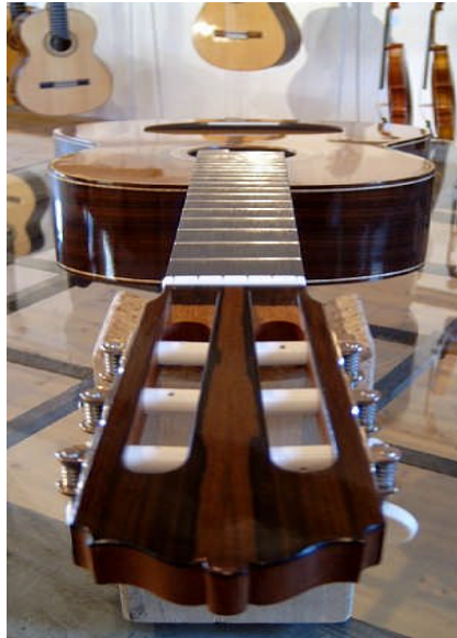
Resim 1.9: Gitarda vernik uygulama ortamı ve gitarın konumu
