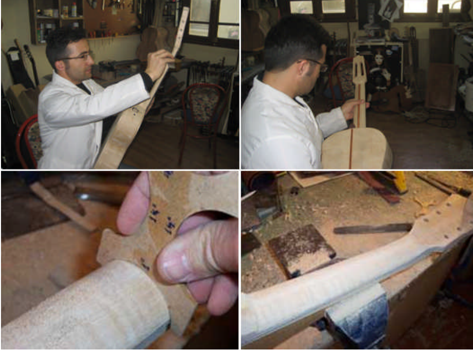
Resim 1.21: Sap formunun sistire ile oluşturulması ve aşama aşama ölçü kontrolü
