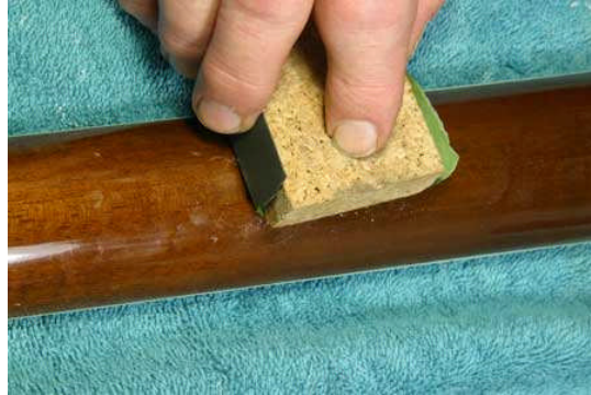
Resim 1.38: Dolgu fazlalıklarının zımparalanması
