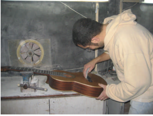
Resim 1.41: Akustik gitara zımpara yapılması ve vernik atılması
