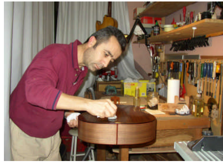
Resim 1.6: Gomalak cila sürülmesi
