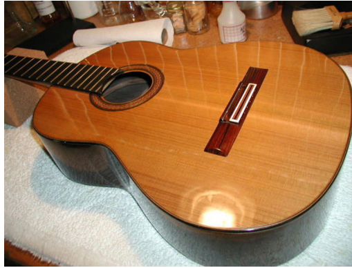
Resim 1.16: Vernik uygulamasında akma kusuru
