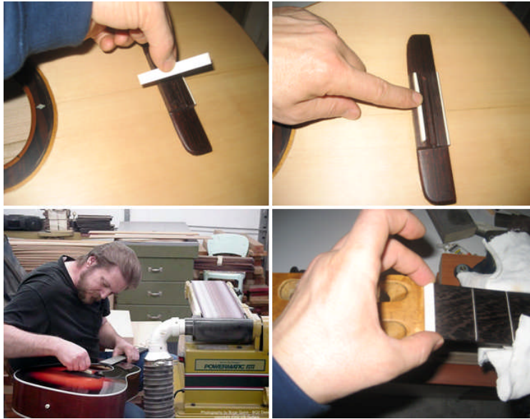
Resim 2.6: Gitarlarda alt ve üst eşik ayarları
