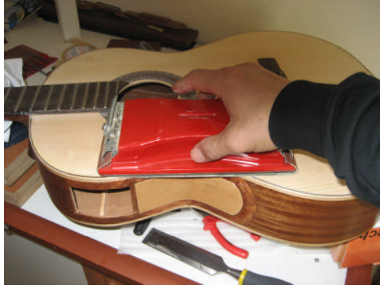
Resim 1.26: Kaba zımparalama ve zımpara takozu
