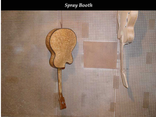
Resim 1.42: Gitarın vernik uygulamaları sonunda kurumaya bırakma pozisyonu ve vernik atımı
