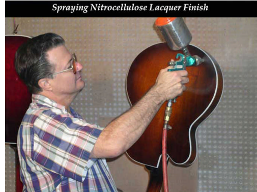
Resim 1.42: Gitarın vernik uygulamaları sonunda kurumaya bırakma pozisyonu ve vernik atımı
