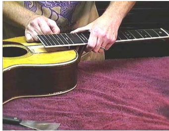
Resim 2.1: Gitarın klavyesinin değiştirilmesi
