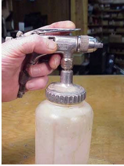
Resim 1.14: Hava basınçlı püskürtme tabancası (pistole)
