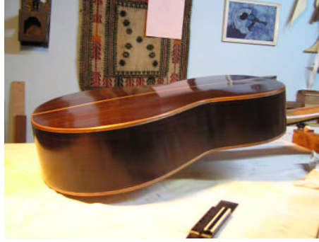
Resim 1.34: Gomalak cilası uygulamasında bitirme cilası
