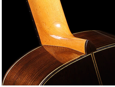
Resim 1.36: Üst yüzey işleme sonucu sapın vernikli görünümü
