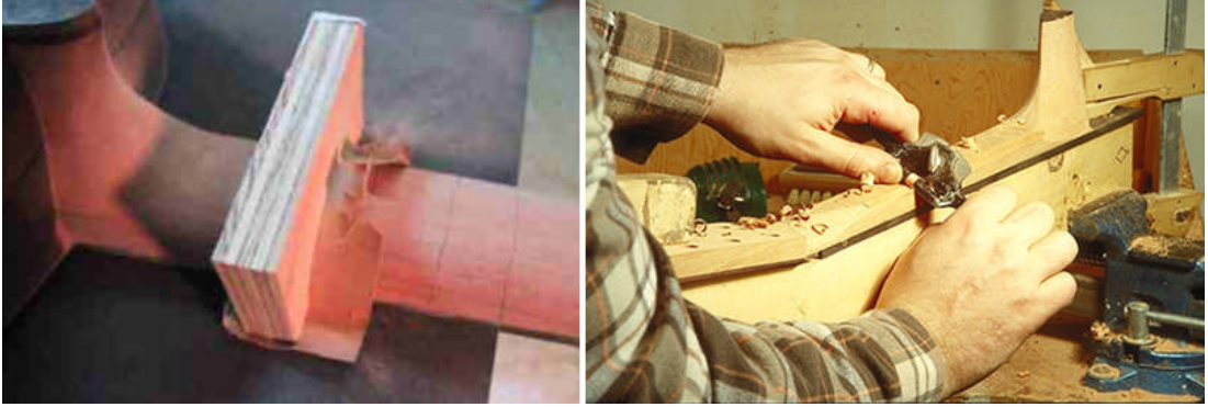
Resim 1.19: Sap bölgesinin mastarla kontrolü ve pastran kolu ile talaş kaldırma işlemi
