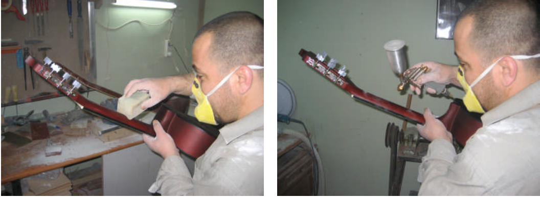
Resim 1.39: Sapa vernik sürme ve atma işlemi
