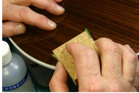
Resim 1.33: Gomalak cilası uygulamasında yüzeydeki pürüzlerin alınması
