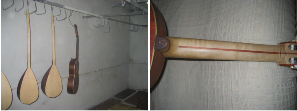
Resim 1.40: Vernikleme sonrası gitarın asma pozisyonu ve cilası bitmiş sap formu
