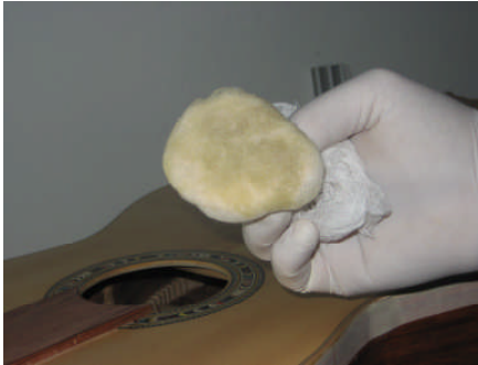
Resim 1.6: Gomalak cila sürülmesi
