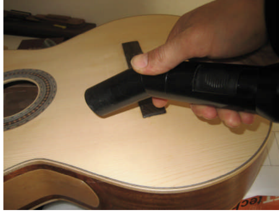
Resim 1.27: Zımparalamada çıkan tozun süpürge ile alınması
