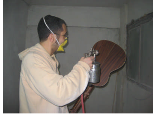
Resim 1.41: Akustik gitara zımpara yapılması ve vernik atılması
