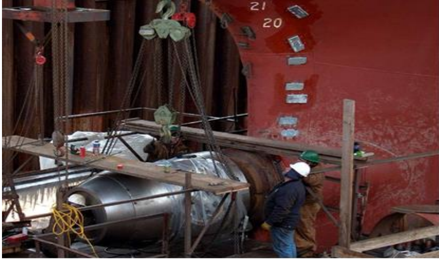
Resim 1.21: Pervane kovanı (stern tübe)
