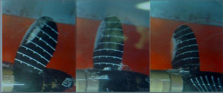
Resim 1.18: Uç girdap kavitasyonu
