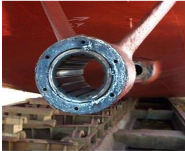
Resim 2.2: Gemi gövdesinden çıkarılmış ara yataklı stern tüp
