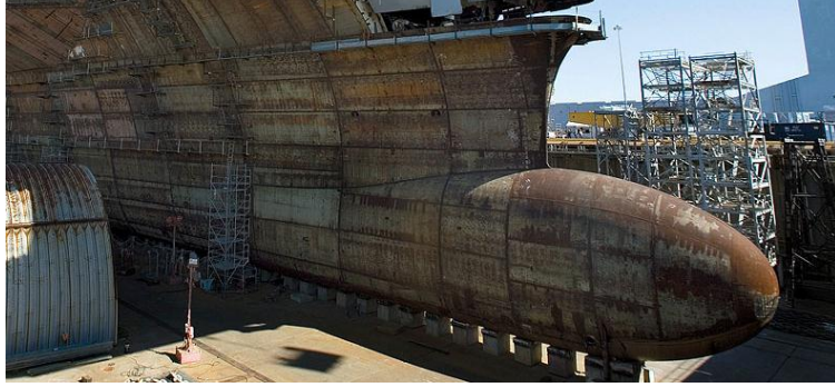
Resim 2.7: Bař blok kaplamasının bitmiř hali
