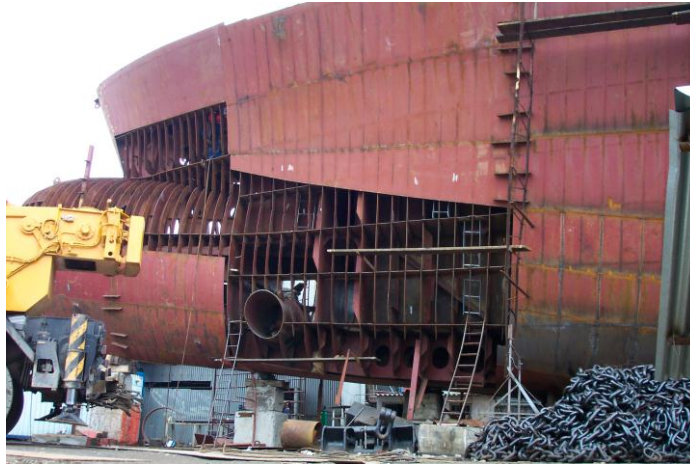
Resim 2.6: Baş blok kaplamasının yapılışı
