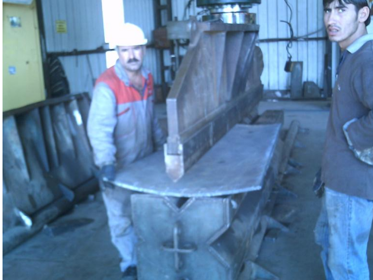
Resim 2.4: Kaplama sacının preste bükülmesi
