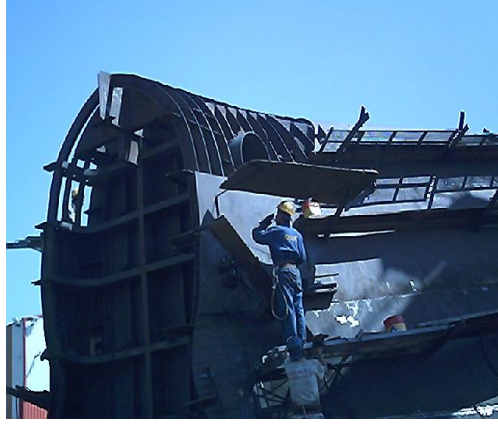
Resim 1.2: Dış kaplama sacları ile burun formunun verilmesi
