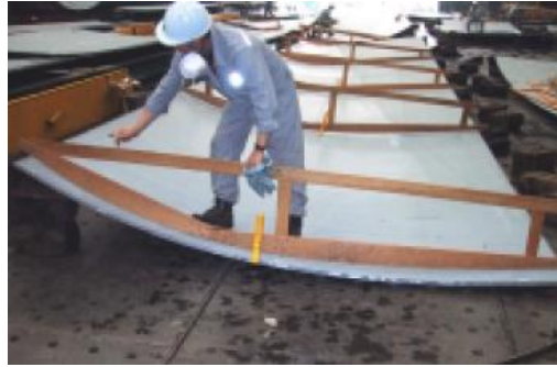
Resim 2.3: Kaplama sacının şablonla büküm kontrolü
