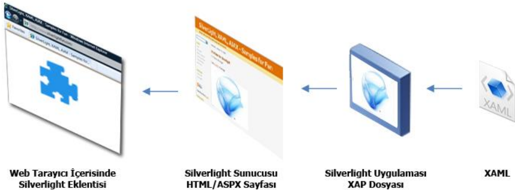
Resim 1.1.: XAML uygulamalarının tarayıcıda çalışma prensibi
