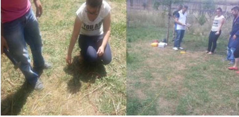
(c) İkinci topraklama çubuğunun çakılması (d) Ölçüm işleminin yapılıp kaydedilmesi
