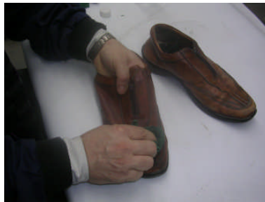
Resim 1.1: Renk değiştirme öncesi yüzey temizliği
