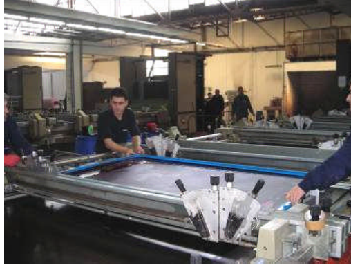
Resim 3.1: Baskı sonrası kalıpların çıkarılması
