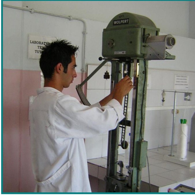
Resim 2. 3: Mukavemet kontrol cihazına numune bağlama
