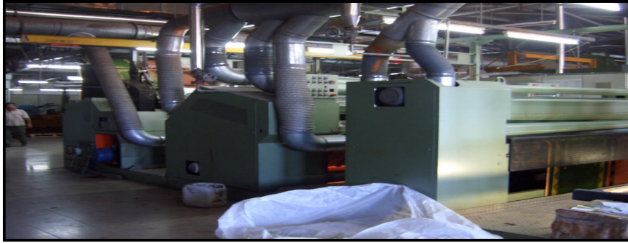
Resim 1.3: İstimli (buharlı) fırçalama makinesi
