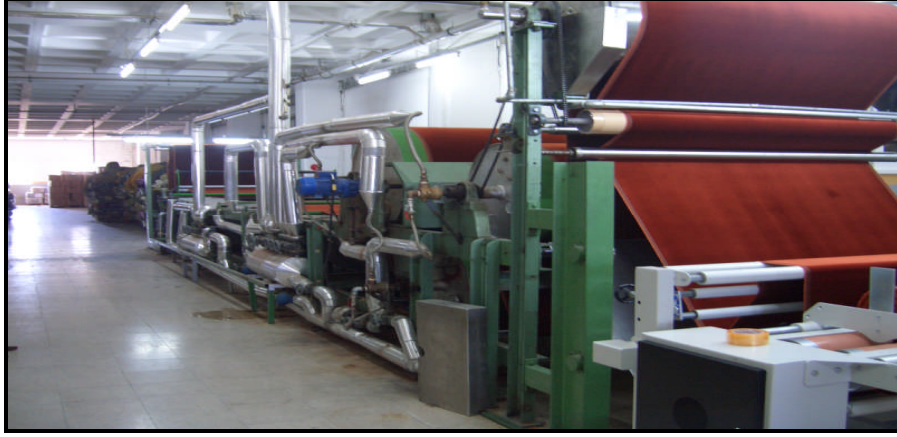
Resim 1.4: Yaş fırçalama makinesi
