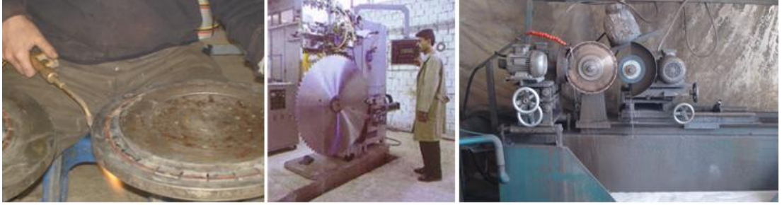
Resim 1.4: Soketlerin gövdeye montajı ve kalibresi
