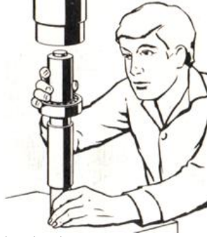
Şekil 2.23: Presle iç bilezik arasına boru parçasının konulması
