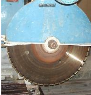
Resim 2.3: Flanşla testerenin bağlanması
