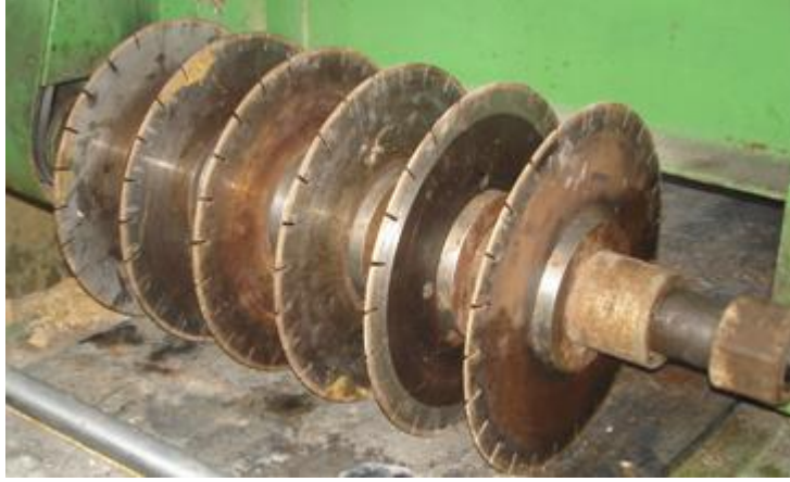
Resim 2.2: Flanşla testerelerin bağlanması
