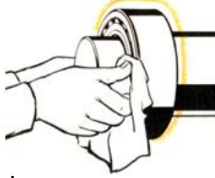
Şekil 2.26: İç bileziğin mil faturasına dayanması
