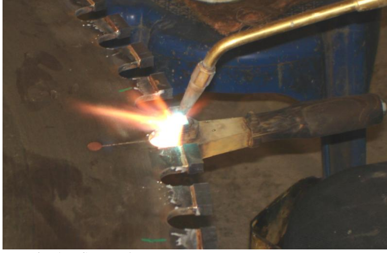
Resim 1.7: Soketlerin kaynak yapılarak testereye tutturulması
