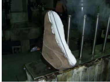
Resim 1.4: Sayanın burun kısmına buhar verilmesi
