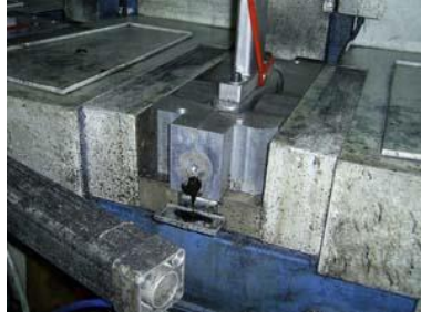
Resim 1.8: PU ham maddenin kalıp içine enjekte edildiği kısım
