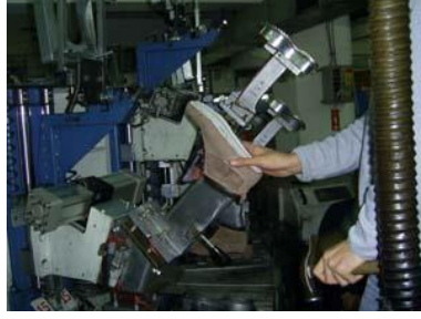
Resim 1.5: Sayanın kalıba geçirilmesi
