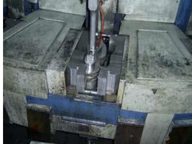
Resim 1.7: Kalıbın kapanmış hâli
