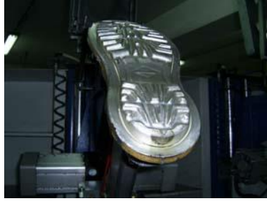
Resim 1.6: Tabanın alt kısmına şeklini veren kalıp parçası
