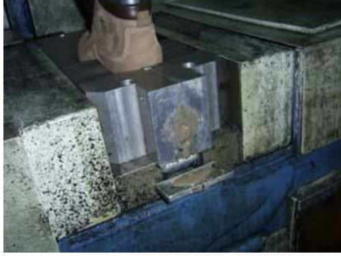
Resim 1.11: Alt kalıbın içine kahverengi PU malzemenin enjekte edildiği kısım
