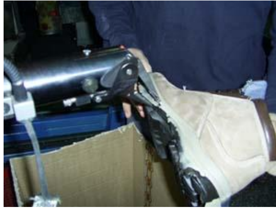
Resim 2.1: Taban kenarındaki çapakların alınması
