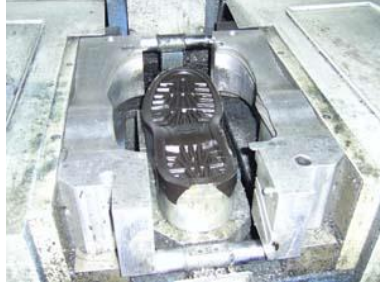
Resim 1.9: PU tabanın alt kısmının basılmış hâli
