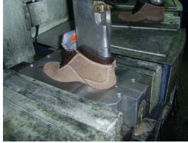
Resim 1.10: Üst kalıbın alt kalıba geçip alt kalıbın kapanmış hâli
