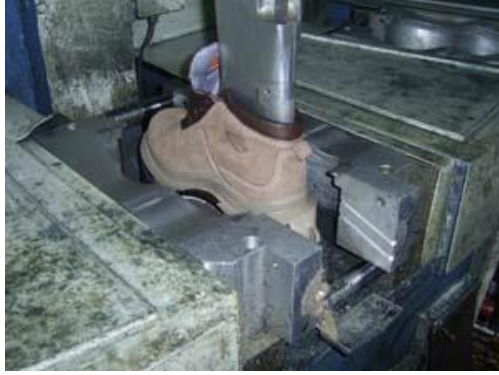
Resim 1.12: Tabanı bitmiş ayakkabının kalıp içinden çıkması
