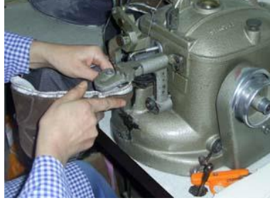
Resim 1.2: Strobrel dikiş makinesinde sayaya taban astarı dikilmesi
