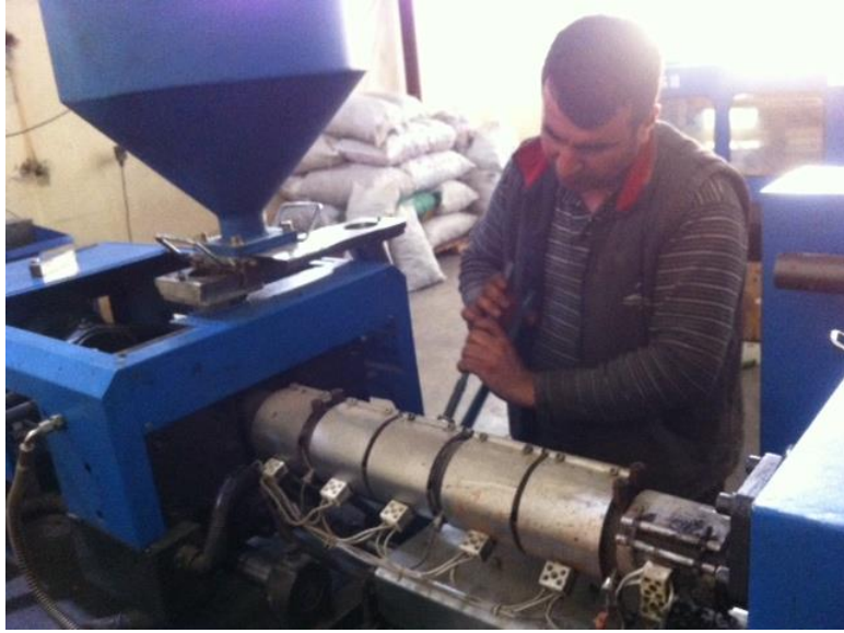
Resim 1.11: Enjeksiyon vidasının sökülmesi
