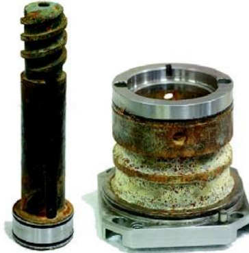
Resim 1.4: Paslanmış ve kireçlenmiş soğutma ünitesi elemanları
