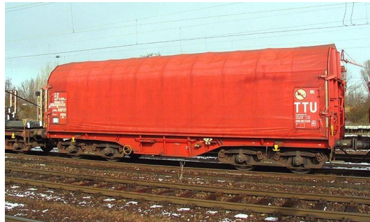
Resim 1.15: Patlayıcı madde yüklü vagonlarda muşamba kullanımı
