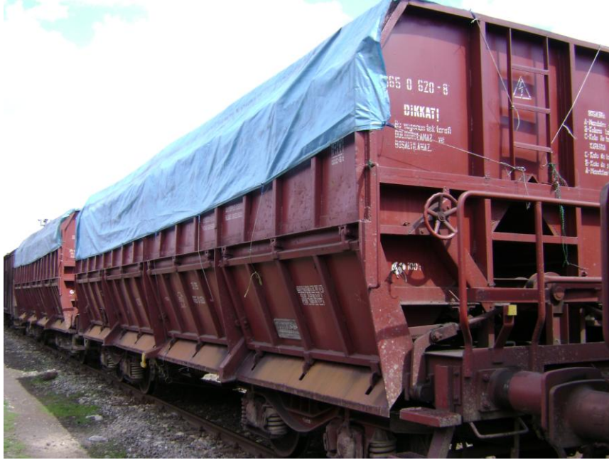
Resim 1.13: Eşyaların muşamba ile korunması
