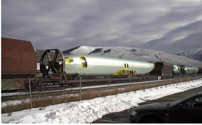
Resim 3.2: Yükün özelliği ve ağırlığı veya boyutları nedeniyle kullanılan özel vagon
