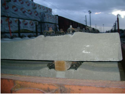
Resim 1.4: Traverste takoz uygulaması
