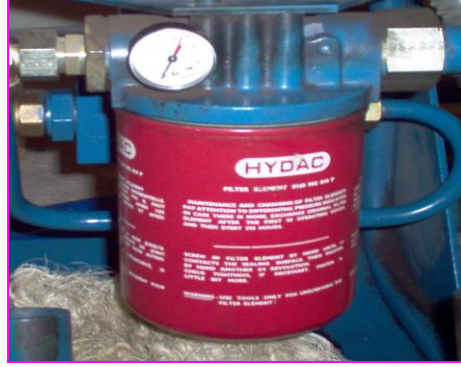
Şekil 1.17: Tank ve üzerinde kirlilik göstergesi
