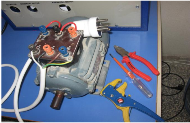
Üç fazlı asenkron motor klemens bağlantısı
