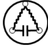
Şekil 3.4 Daimi ayrık kapasitörlü tek fazlı motor sembolü
