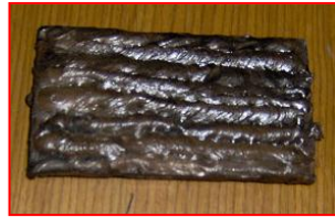
Resim 3: Hatalı yüzey dolgu kaynağı
