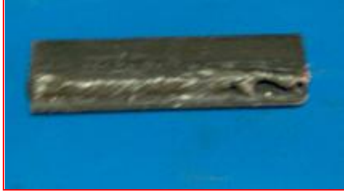
Resim 7: Hatalı bindirme kaynağı
