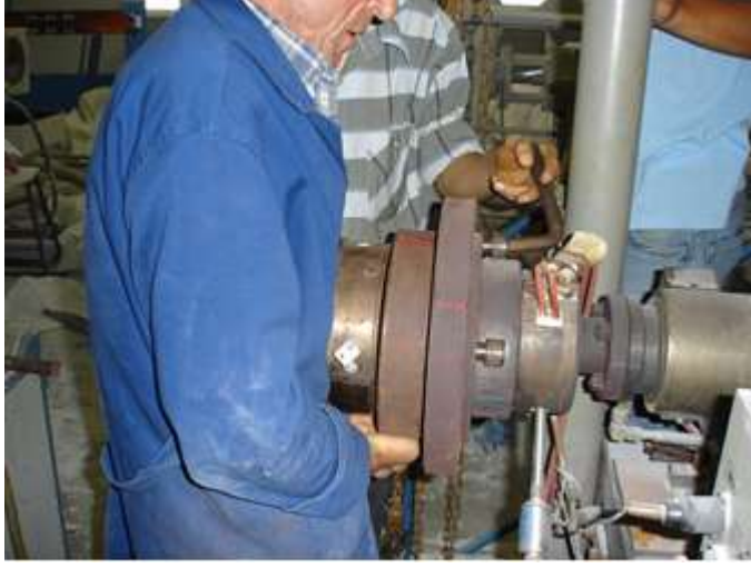
Resim 1.4: Ekstrüzyon kalıplarının montajı
