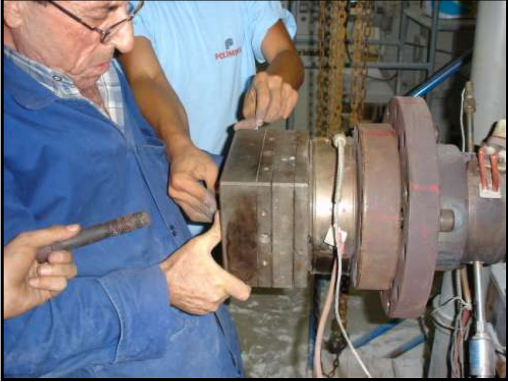
Resim 1.5: Ekstrüzyon kalıplarının montajı
