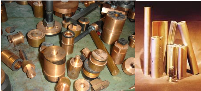
Resim 1.46: Çeşitli tip elektrotlar
