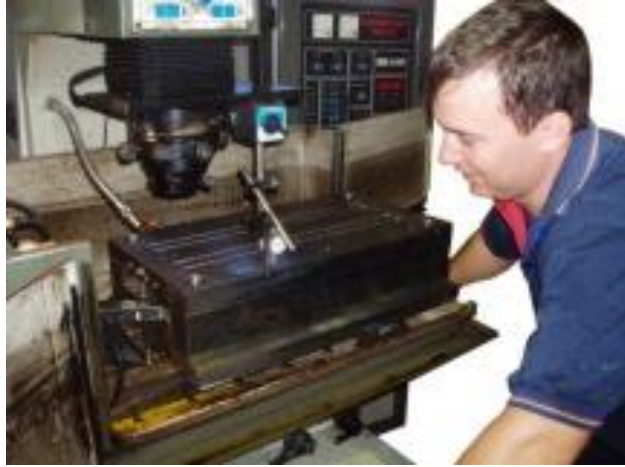
Resim 1.52: Komparatörle dikliğin ayarlanması
