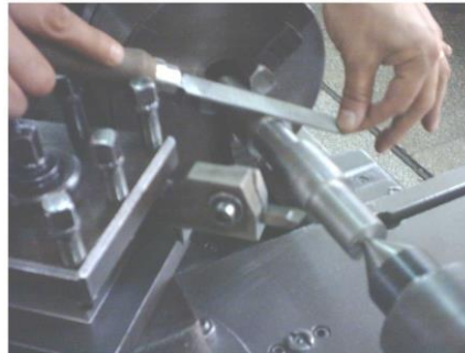
Resim 1.26: Eğe ile tornada kademelere pah kırma
