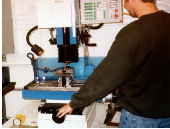
Resim 1.53: Elektrot ve iş parçasının merkezlenmesi
