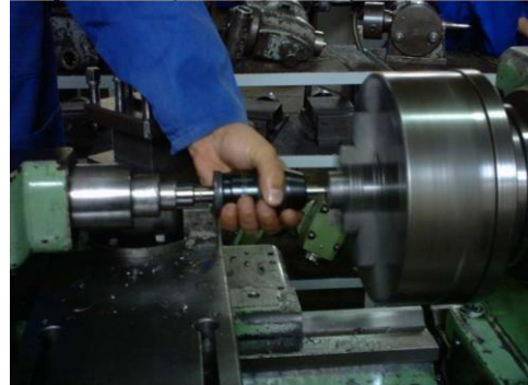
Resim 1.20: Punta deliği açma işlemi
