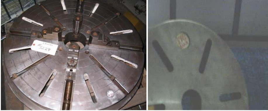
Resim 1.11: Mengeneli ayna ve delikli düz ayna
