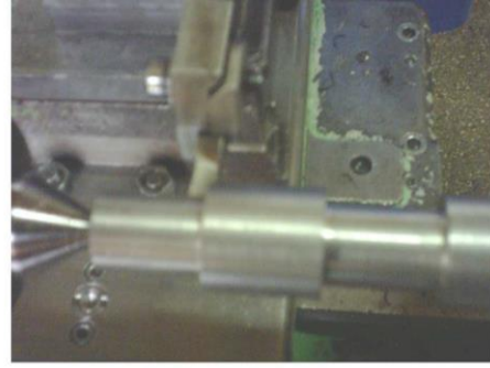
Resim1.25: Sağ dik yan yüzeyleri tornalamak
