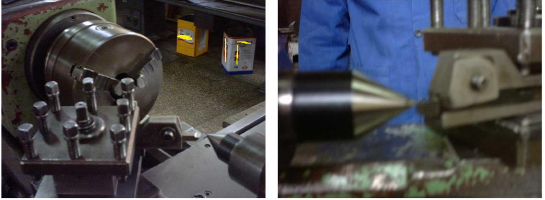
Resim 1.8: Kesicinin kalemlige bağlanması
