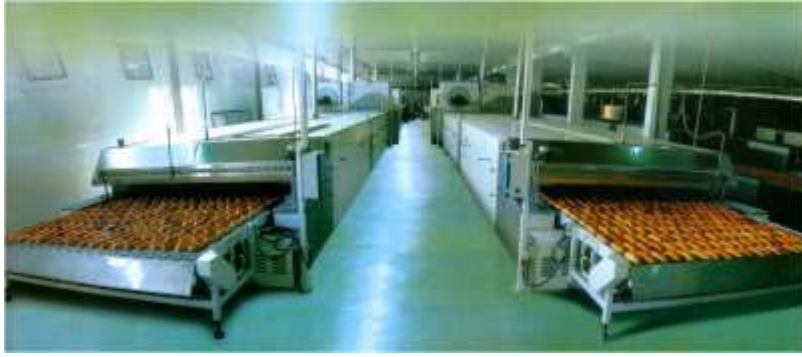
Resim 1.3: Tünel tipi ekmek fırını
