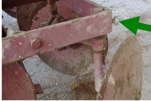
Resim 2.14: Kapatıcı diskte derinlik ayarı ayar civatası
