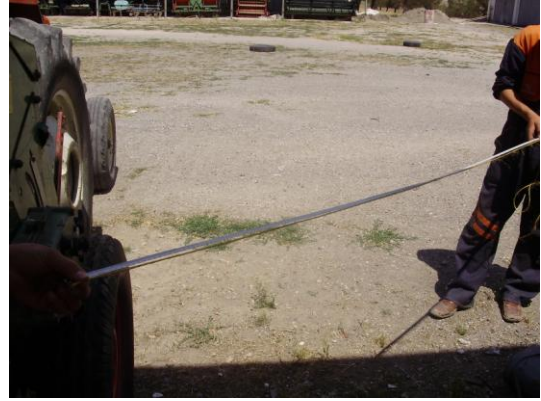
Resim 1.13: İp uzunluğunun ölçülmesi
