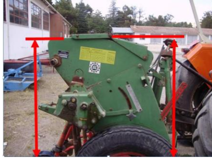
Resim 1.3: Ön arka paralellik kontrolü
