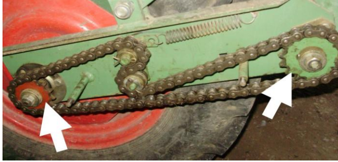
Resim 2.9: Gübre dişli ayar düzeni
