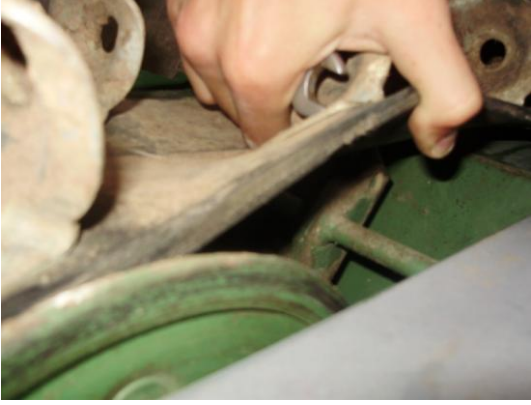
Resim 2.17: Götürücü kayış kontrolü Resim 2.18: Götürücü kayış ayarı
