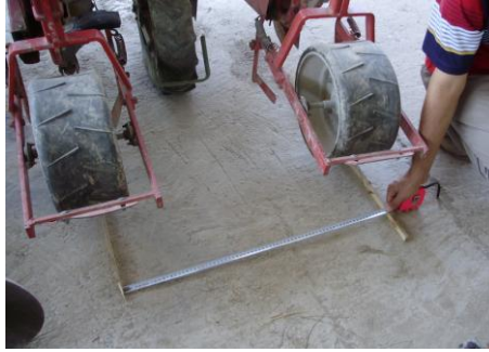
Resim 1.6: Anıza özel dane makinelerinde sıra arası mesafe
