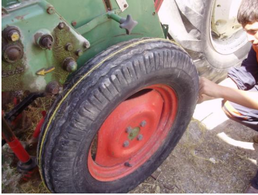
Resim 1.12: Tekerlek çevresinin iple ölçümü
