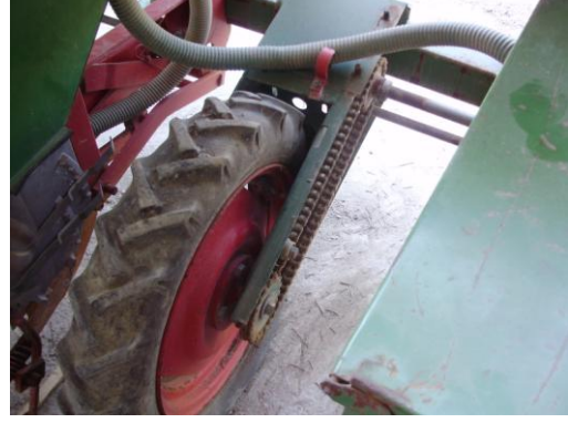
Resim 1.23: Gübre dişli ayar düzeni
