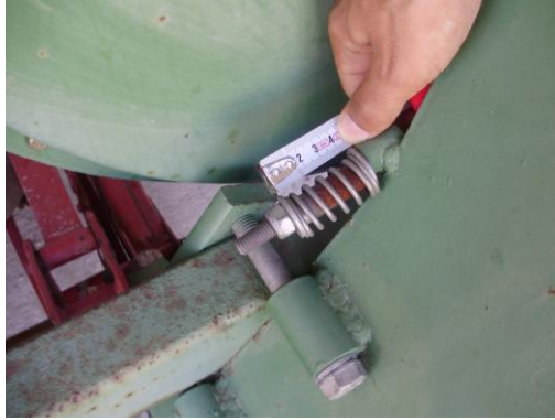
Resim 1.37: Aspiratör gergi milinden kayış ayarı kontrolü
