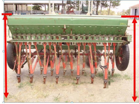
Resim 1.4: Sağ sol paralellik kontrolü
