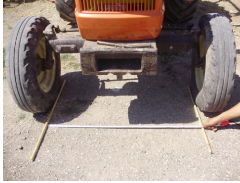
Resim 1.25: Traktör ön tekerlekleri arası mesafe (içten içe)
