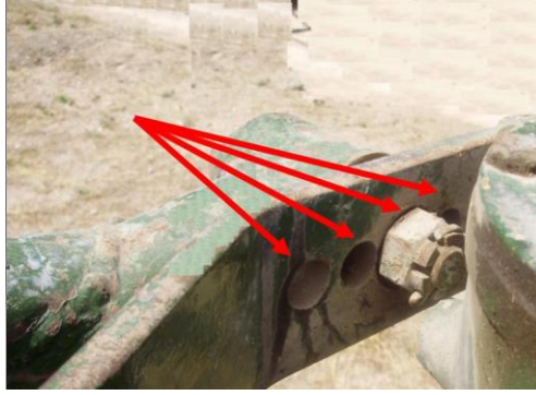
Resim 4.1: Bağlantı çatısındaki düşey ayar kademe delikleri
