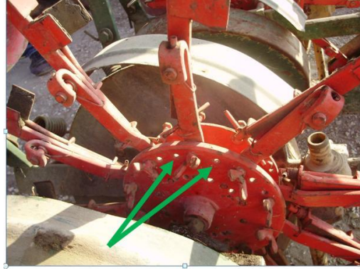
Resim 3.7: Kısaçların yerlerinin değiştirilmesi ile sıra üzeri mesafe ayarı
