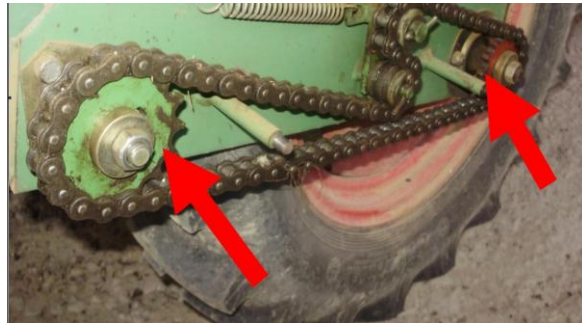
Resim 2.8: Zincir dişli değişimi ile sıra mesafe ayarı
