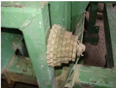
Resim 2.7: Sıra üzeri mesafe ayar yedek dişlileri
