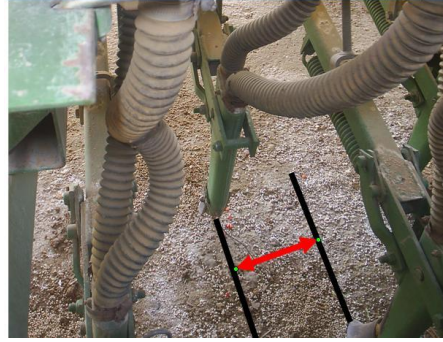
Resim 1.5: Anıza hububat ekim makinelerinde sıra arası mesafe
