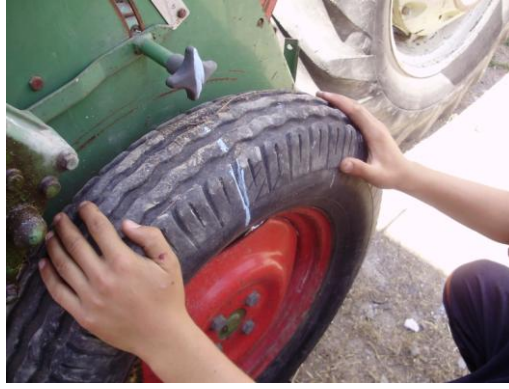
Resim 1.14: Tekerleğin işaretlenmesi ve çevrilmesi
