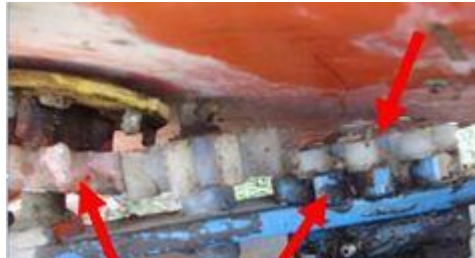
Resim 3.4: Dişli değişimi ile sıra üzeri mesafe ayarı
