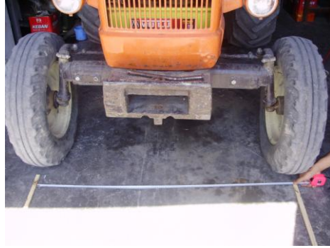
Resim 1.24: Traktör ön tekerlekleri arası mesafe (ortadan ortaya)
