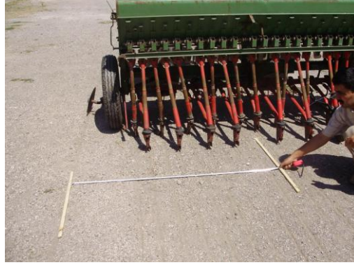
Resim 1.27: Makinenin orta noktasından itibaren markör uzunluęu Ayrıca markörler diskli ise ařağıdaki řekilde ayarlanmalıdır.
