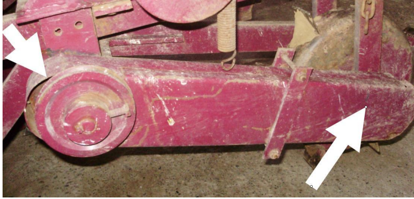
Resim 2.6: Keççeli zincirli dikim makinelerinde sıra üzeri mesafe ayarı
