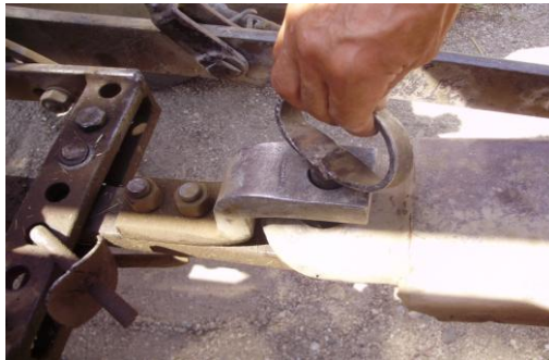
Resim 1.2: Makine çeki okunun traktör çeki kancasına bağlanması
