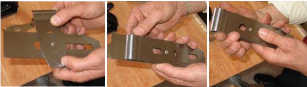
Resim 48: Rende tığ kapağının takılması
