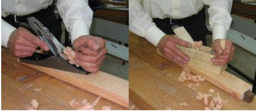
Resim 49: Tezgâh demirleri arasına sıkıştırılmış iş parçasının rendelenmesi
