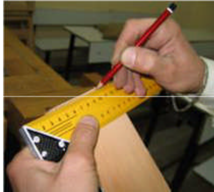
Resim 52: Gönye ile iş parçası boyunun markalanması
