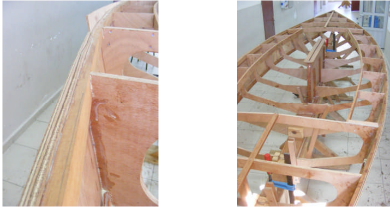
Resim 50: Teknenin bordasının cumba rendeleme
