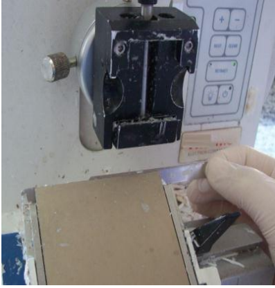
Resim 3.3: Disposable bıçak takılması
