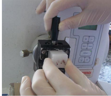
Resim 3.5: Blok tutucuya blok yerleştirilmesi
