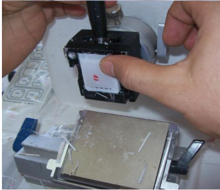
Resim 3.5: Blok tutucuya blok yerleştirilmesi
