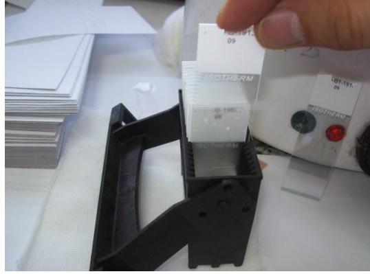
Resim 3.11: Doku kesiti alınmış lamın doku taşıma sepetine yerleştirilmesi
