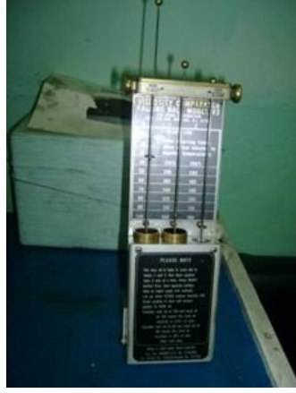
Resim 5.1: Düşen top tipi viskozite metre
