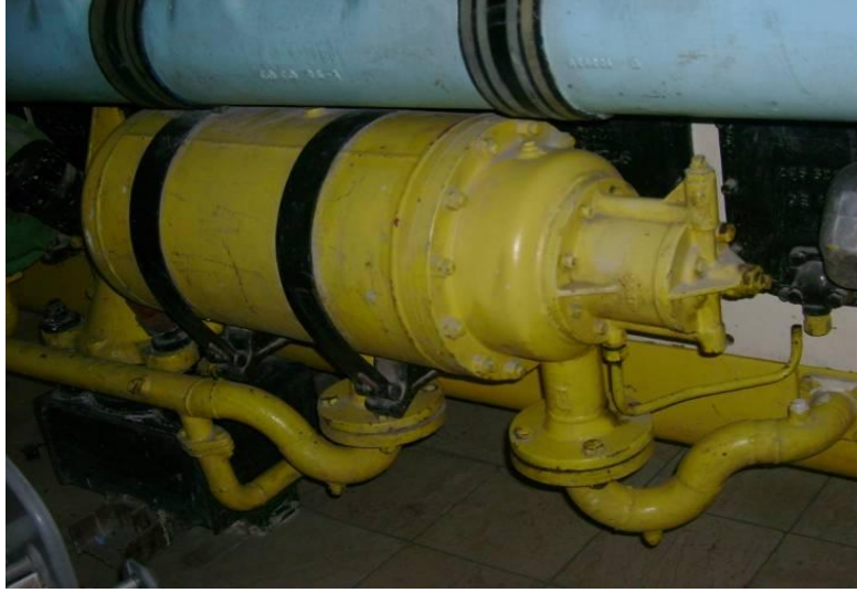
Resim 2.1: Dizel motor yağ filtresi
