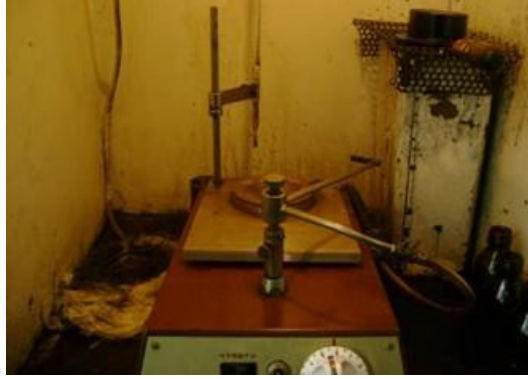
Resim 5.4: ASTM D 92-57 açık kap deneyi cihazı
