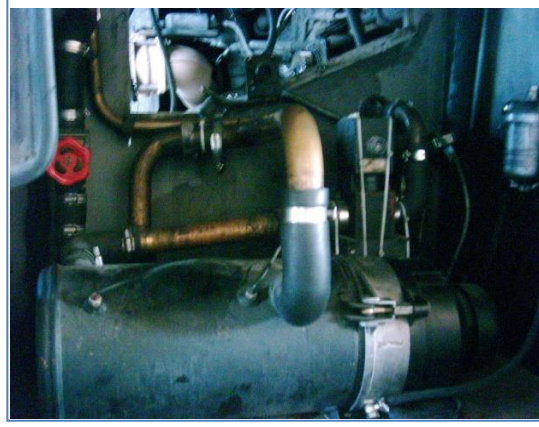
Şekil 3.3: Haricî ısıtma sistemi (sulu vebosta)
