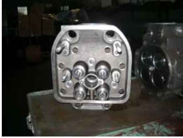
Resim 3.4: Enjektörün silindir başlığındaki yeri
