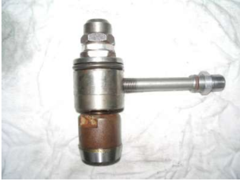
Şekil 3.1: Enjektör memesi ve enjektör
