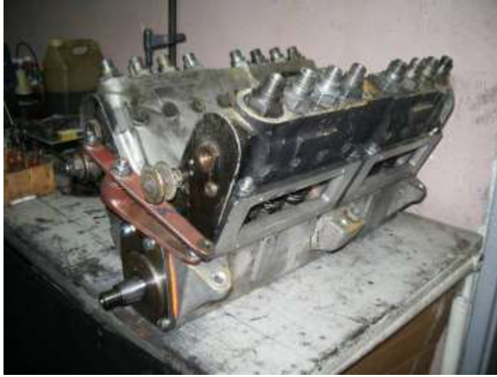
Resim 4.3: Sıra tipi yakıt enjeksiyon pompası
