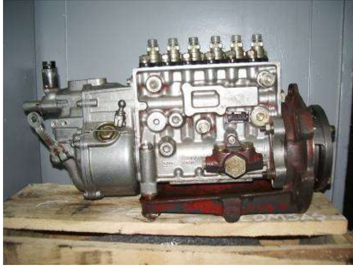
Resim 4.2: Sıra tipi yakıt enjeksiyon pompası
