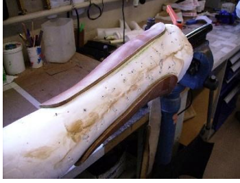
Resim 2.6: Alt ve üst manşetin anteriordan kesilip hazırlanmış görüntüsü
