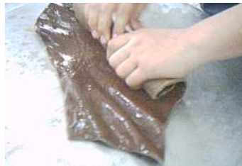
Resim 1.16: Derinin yuvarlanarak katlanması
