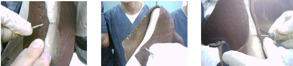
Resim 1. 35: Kenarların biz ile delinmesi
