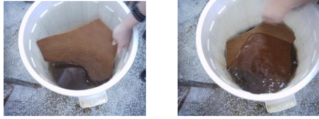
Resim 1.14: Derinin su içinde bekletilerek yumuşatılması
