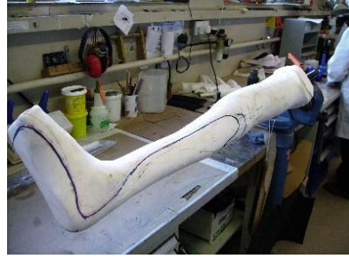
Resim 2.11: Manşetin derin çekime hazırlığı
