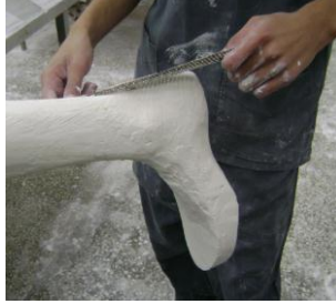
Resim 2.11: Alçı raspaı ile yüzeylerin düzeltilmesi
