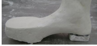
Resim 2.19: Parmak ucu ile yer arasındaki 1 cm boşluk
