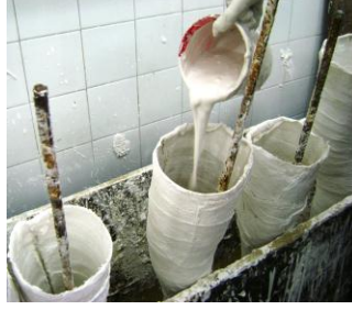
Resim 2.7: Negatif alçı kalıbı doldurma
