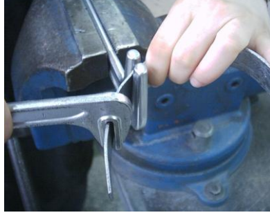
Resim 1.9: Eğim anahtarının mengeneye bağlanması ve eğimi
