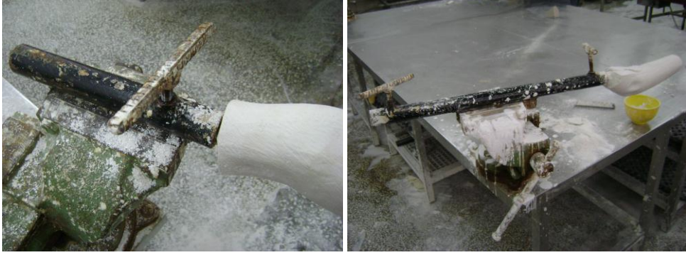
Resim 1.15: Özel tasarım iki yönlü mengene aparatı
