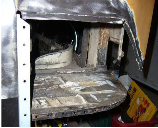
Resim 2.7: Paslanan kısmın kesilmesi
