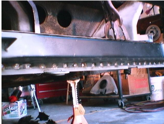
Resim 2.5: Direnç kaynağıyla marş biyel onarımı
