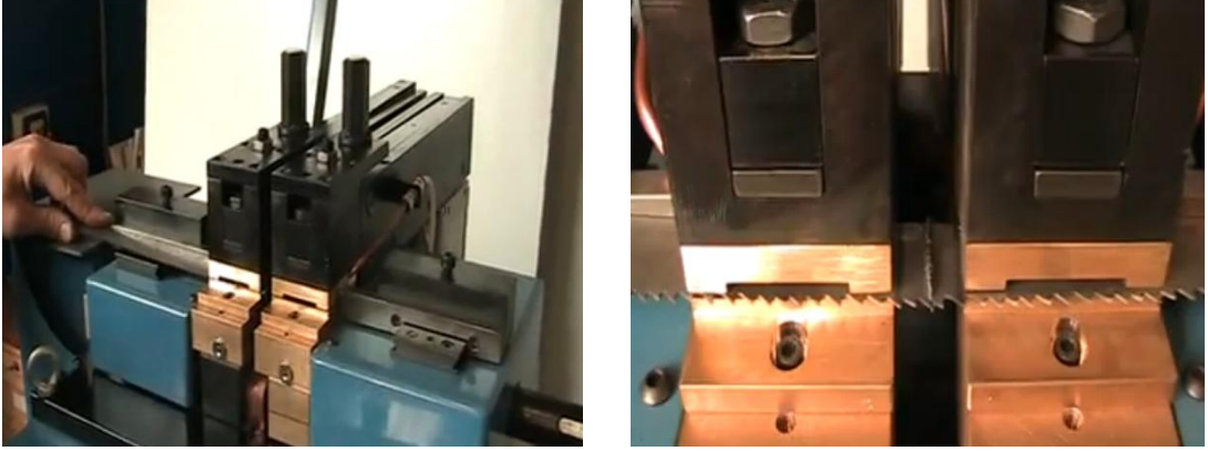
Resim 2.11: Direnç alın kaynak makinesi ve testere lamasının kaynatılması
