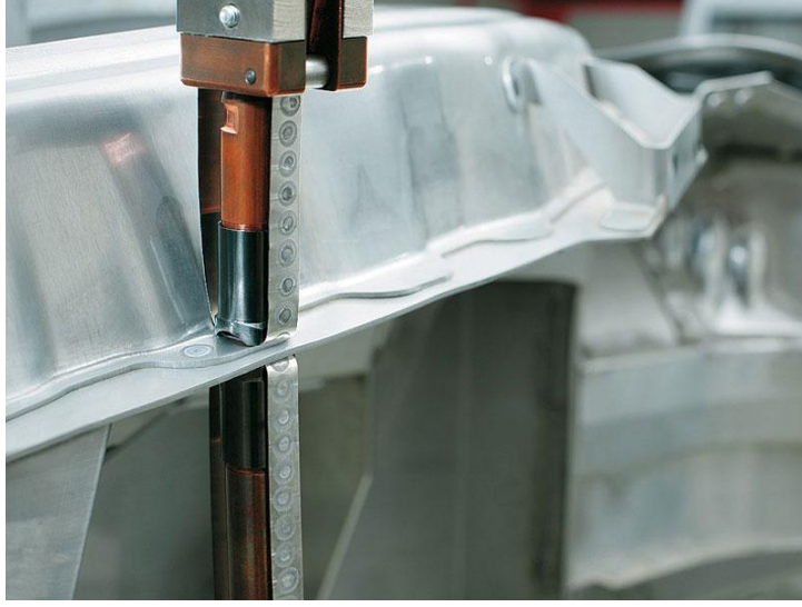
Resim 2.4: Özel elektrotla otomobil kaportasının kaynatılması
