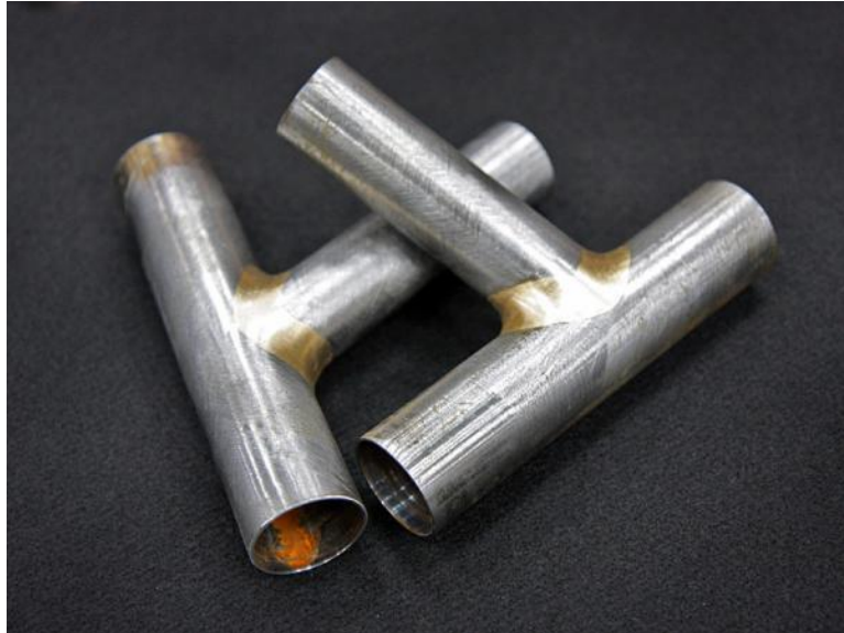
Resim 6.4: Sert lehimle birleştirilmiş borular
