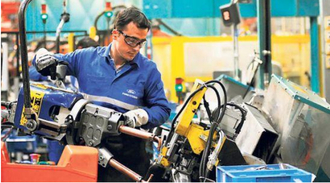
Resim 2.3: Direnç kaynağıyla montaj
