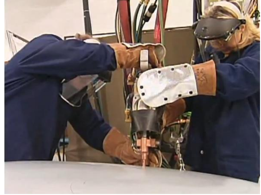
Resim 1.6: Taşınabilir nokta kaynak makinesi ve kullanımı
