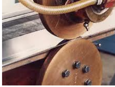
Resim 3.5: Disk elektrotlar arasında iş parçası
