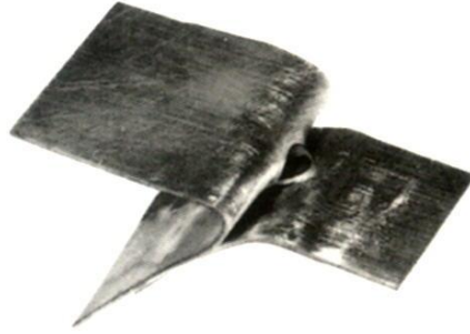
Resim 1.3: Nokta kaynağıyla elde edilen, sökülemez birleştirme
