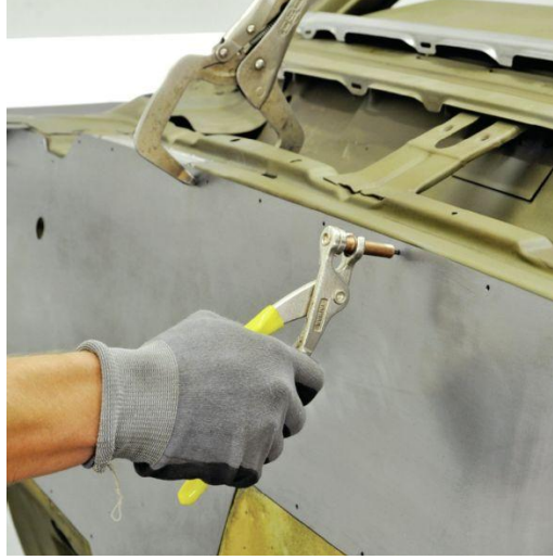
Resim 9.4: Otomobil karoserinde perçin kullanımı
