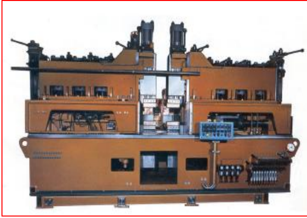
Resim 2.2: Direnç alın kaynak makinesi ve kaynak bölgesi detayı
