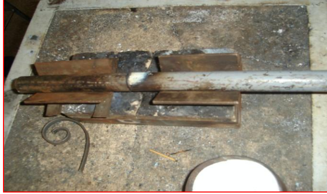
Resim 5.1: Boruların lehim öncesi hazırlığı
