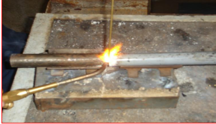
Resim 5.2: Sert lehim boru birleştirme
