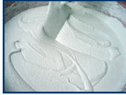
Resim 2.1: Derz dolgu (fuga) harcı kıvamı
