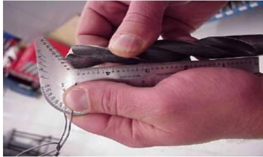
Resim 1.3: Sabit açı gönyeleri ile bilenen matkap kontrolü
