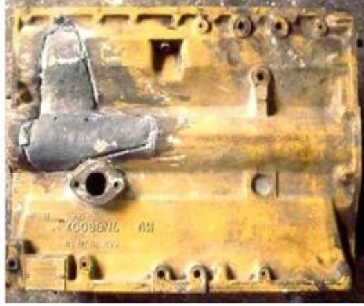
Resim 1.3: Kırık parçaya dış açılmış yamanın puntalanması
