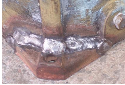
Resim 1.5: Dökme demire çekilmiş kaynak
