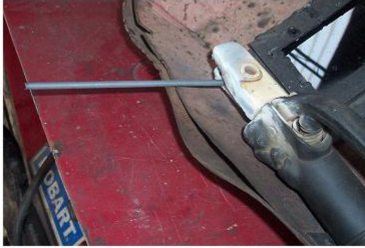
Resim 1.2: Kaynak pensine takılmış dökme demir elektrot
