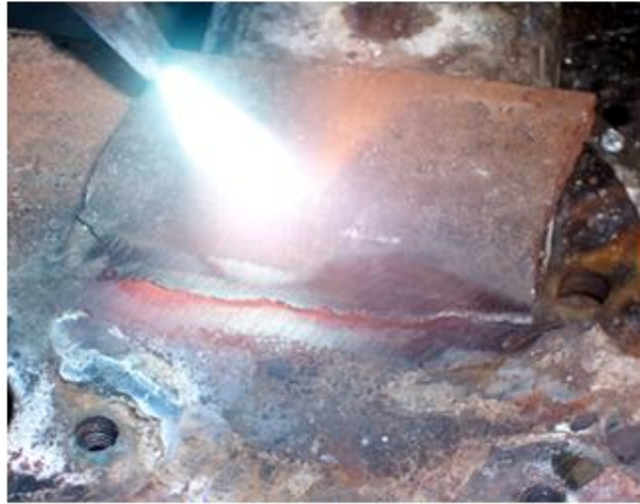
Resim 2.1: Kırık dökme demir kaynağı
