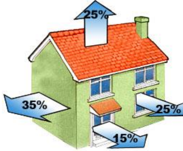
Resim 1.1:Yapılarda ısı kayıpları
