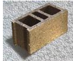
Resim 1.2: BI-20 (20x40x20) Üç boşluklu blokbims
