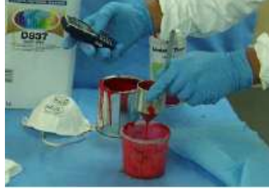
Resim 1.2: Viskozite kabı ve karıştırma oranları ayarlama
