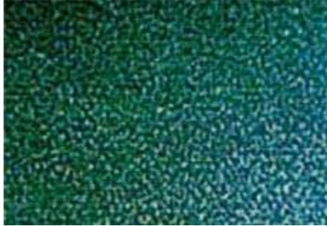
Resim 2.3: Kuru püskürtme hataları
