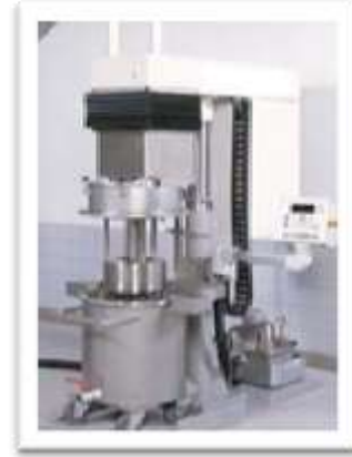
Şekil 2.1: Basket mill yapısı
