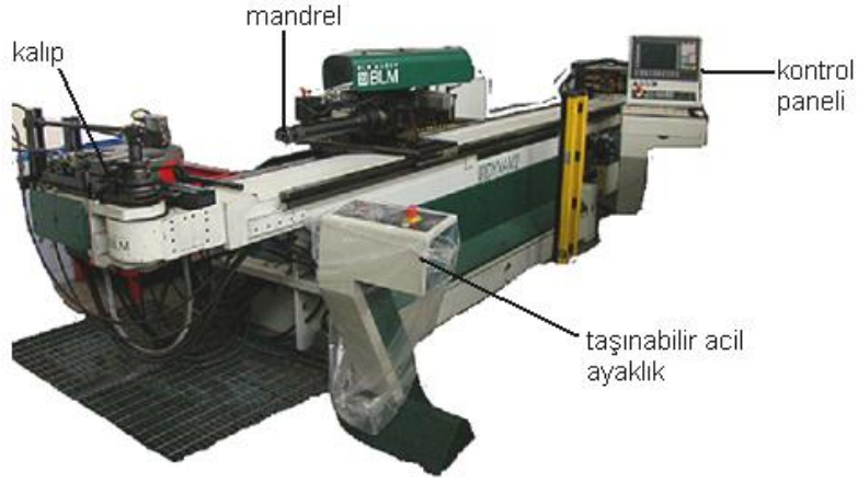
Resim 2.6: CNC mandreli bükme makinesi
